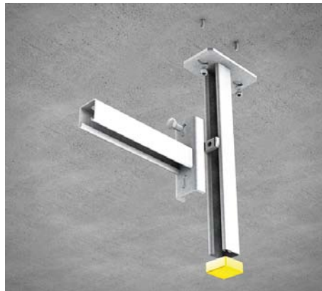
5 | Deckenmontage mit Konsolhalter KDAG 41 Die Montage erfolgt mittels zweier Dübel, z.B. SD 10/10*. Die Konsole KA 41 wird mit Schraubensatz SES 10x20* und Anker Mutter AMF22 M10* befestigt. Die optionale Schutzkappe SA* wird von unten aufgeschoben.
