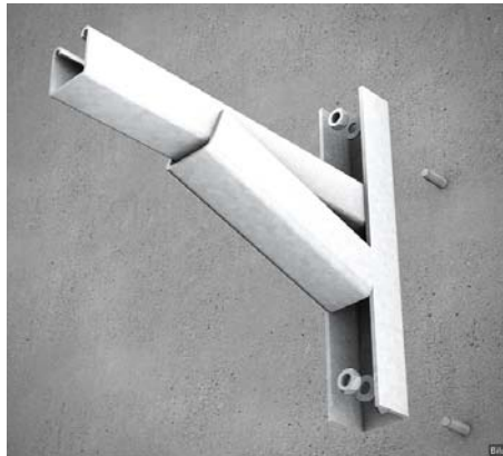
2 | Wandmontage mit schwerer Konsole KWSS Die Montage erfolgt mittels zweier Dübel, z.B. SD 12/10*, in der obersten und untersten Bohrung.
